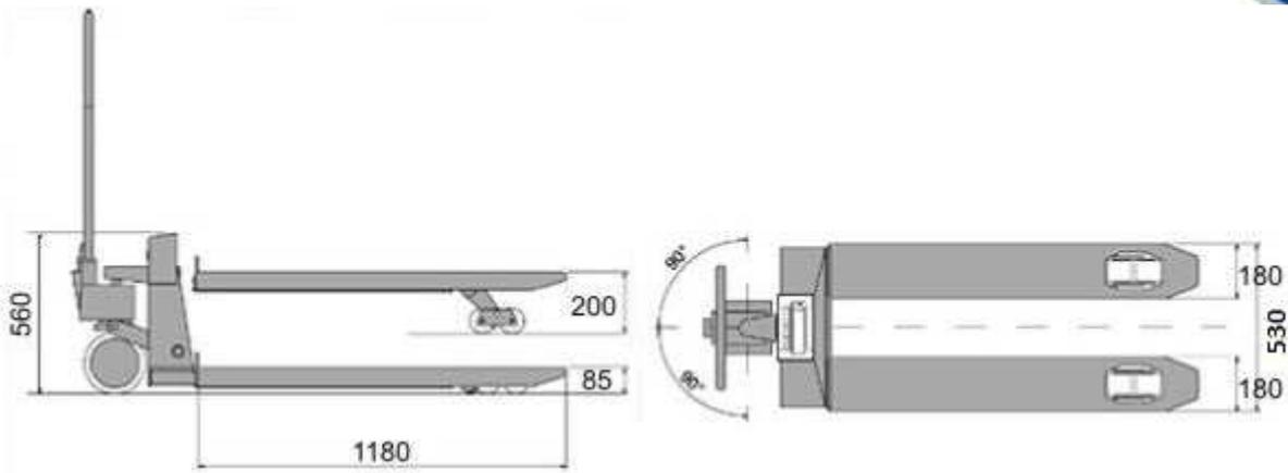
Schema delle dimensioni del muletto pesatore con bilancia interna.
