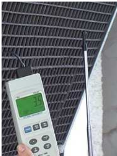
Termooanemometro PCE-009 mentre effettua una misura all'uscita di un estrattore di fumo.
