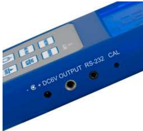
Qui potrà vedere i diversi ingressi ed uscite dell'analizzatore di rumore LEQ
