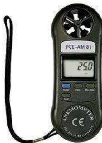
Anemometro per la velocità del vento
