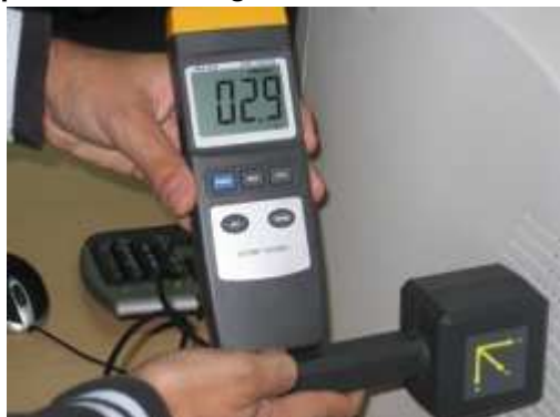
Gaussimetro per campi elettromagnetici PCE-G28 mentre controlla le radiazioni emesse da un PC
