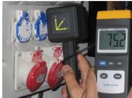
Misura delle radiazioni elettromagnetiche emesse da un quadro elettrico
