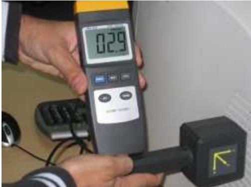
Misuratore di radiazioni per campi elettromagnetici PCE-G28 mentre controlla le radiazioni emesse da un PC
