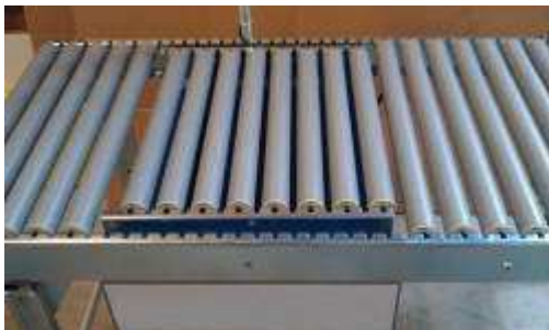
Visione frontale della bilancia su nastro con rulli
