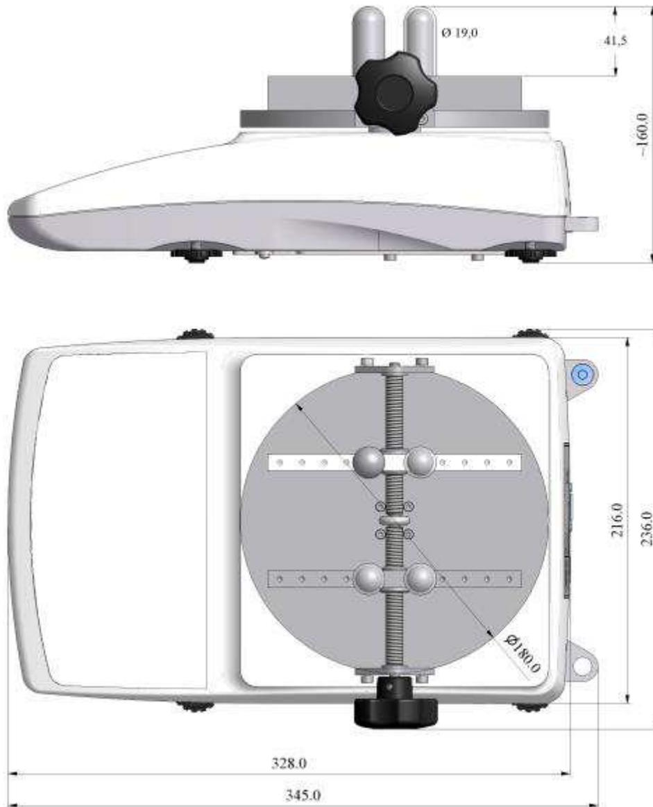
Dimensioni del torsiometro per elementi di fissaggio filettati della serie PCE-TTM
