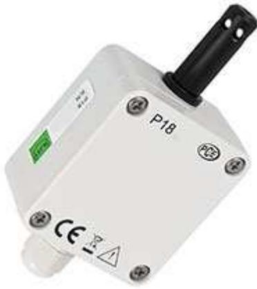
L'unità del sensore misura temperatura e umidità. Si possono monitorare anche altri parametri del sistema di controllo per magazzini attraverso l'interfaccia. L'unità del sensore viene spedita pronta per il collegamento, basta collegarla mediante un cavo di connessione all'unità principale del misuratore di temperatura e umidità. L'unità principale riconoscerà il sensore immediatamente e basterà aggiungerlo alla configurazione.
