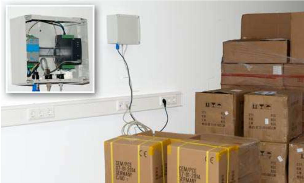
Il modulo di manutenzione remoto per il controllo dei magazzini e l'alimentatore sono dotati di cablaggi pronti per il montaggio su parete, evitandole così di dover effettuare questa installazione. Basta configurare i parametri di rete. Consigliamo di collocare l'unità principale del sistema di controllo per magazzini vicino a un'interfaccia di rete e da lì collegare il PCE-WMS 1 via LAN. Il collegamento dei sensori viene effettuato a parte tramite il connettore RJ45 aggiuntivo.
