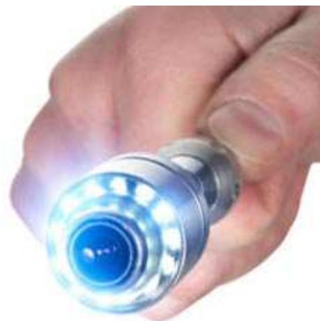
Illuminazione della mini videocamera dell'endoscopio mediante i 12 LED bianchi.
