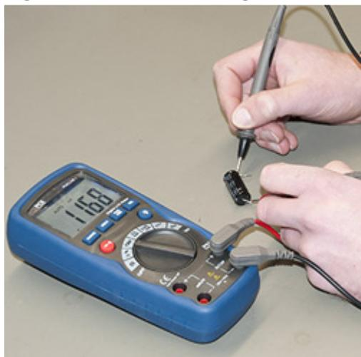
Il misuratore LCR PCE-LCR 1 mentre misura la capacità.
