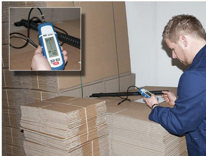
Controllo nell'entrata delle merci con il misuratore di umidità universale.
