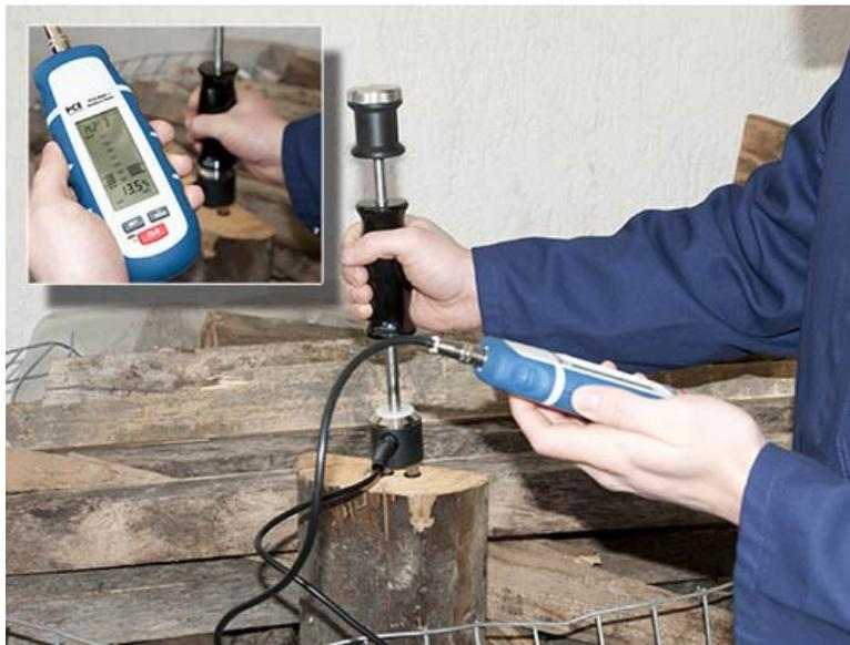
Il misuratore di umidità mentre misura un elettrodo esterno.
