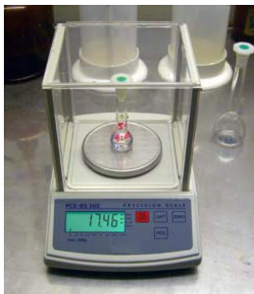
Questa bilancia può essere utilizzata ad esempio per pesare le diverse componenti di una miscela chimica. A modo di controllo possono essere indicati i pesi dei vari componenti al momento di toglierli dalla bilancia. La tara, che può anche essere eseguita più volte, viene effettuata premendo il tasto "→T".
