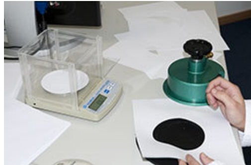
Il campione da 100 cm 2 viene tagliato per la misura
