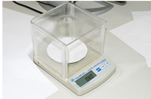
La bilancia per carta e tessuti PCE-DMS 200 misura direttamente in g/m 2
