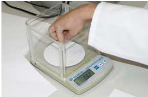
Il campione da 100 cm 2 viene posizionato all'interno della bilancia per carta e tessuti PCE-DMS 200
