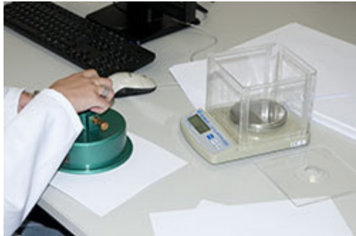
Preparazione del campione rotondo per la bilancia per carta e tessuti PCE-DMS 200
