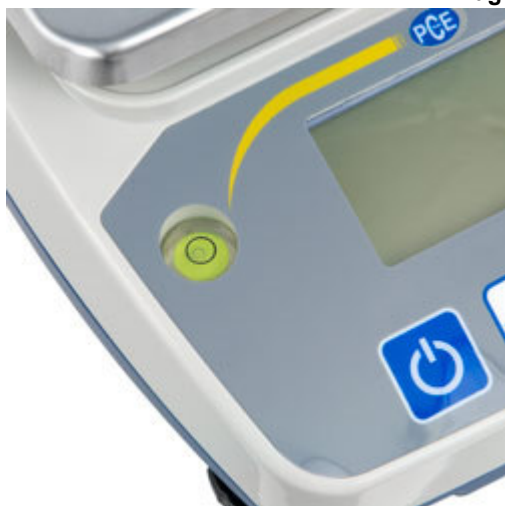
La livella a bolla è ben incorporata alla struttura della bilancia per facilitare il livellamento
