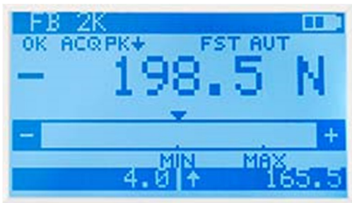
Il display del dinamometro universale offre informazioni su: stato della batteria, frequenza di campionamento, forza e valori min./max.
