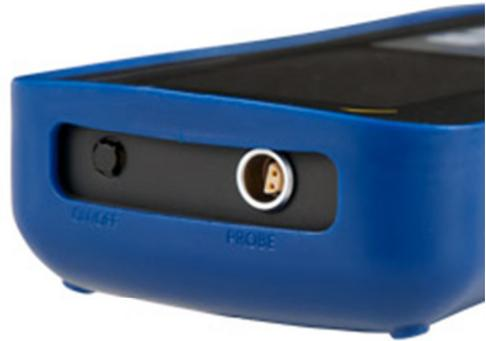
Connessione della sonda
