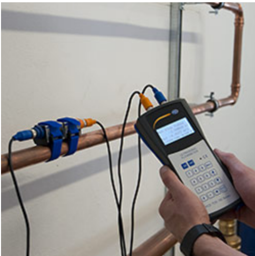
Il misuratore di flusso a ultrasuoni PCE-TDS 100 mentre effettua una misura in una tubatura
