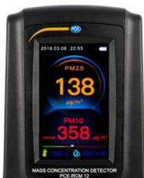
Nella parte inferiore del misuratore viene indicata la temperatura e l'umidità relativa
