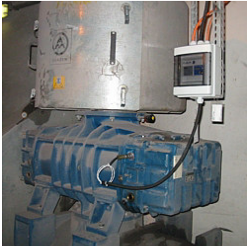
Qui può vedere il monitor per vibrazioni mentre controlla una macchina vibrante
