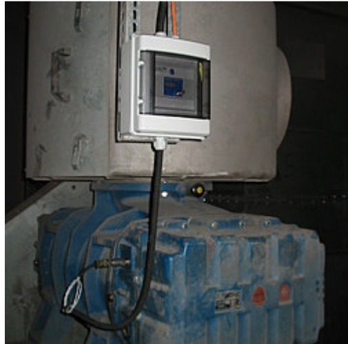
Qui può vedere il monitor per vibrazioni mentre controlla una macchina compattatrice
