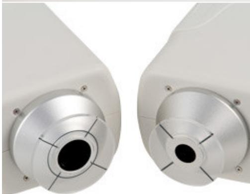
Differenze principali tra il colorimetro PCE-CSM 2 e il PCE-CSM 4. Si differenziano nelle dimensioni del sensore. Il sensore del PCE-CSM 4 è di 20 mm (sinistra), mentre il sensore del PCE-CSM 2 è di 8 mm (destra). Pertanto, con il PCE-CSM 2 è possibile misurare superfici più piccole, molto utile al momento di misurare, ad esempio, il colore degli alimenti.
