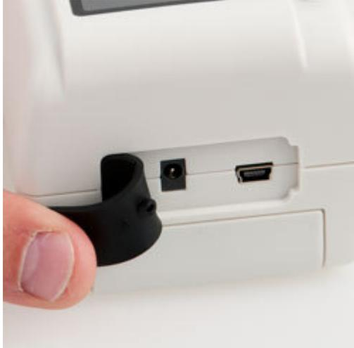
Qui si possono vedere le connessioni del colorimetro PCE-CSM 2 e PCE-CSM 4. Da una parte, il colorimetro ha un connettore per l'alimentatore che consente di ricaricare la batteria al litio (immagine a sinistra). È possibile collegare il colorimetro anche a un PC o stampante mediante l'interfaccia USB e così analizzare e salvare i dati tramite il software incluso nella spedizione.
