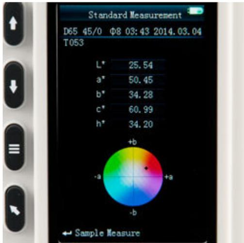
Interfaccia utente del colorimetro PCE-CSM 2 e PCE-CSM 4 durante una misura. La schermata appare una volta che si è messo in funzione il colorimetro. Il dispositivo è immediatamente pronto per effettuare la misurazione. Il colorimetro visualizza, oltre ai singoli valori, anche il risultato a colori, come si può vedere nell'immagine.
