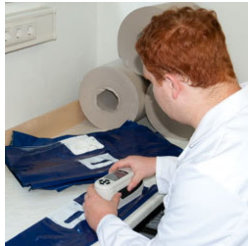
Il colorimetro, come in questo esempio, può essere utilizzato per verificare anche le superfici riflettenti
