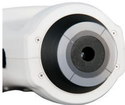
Qui può vedere il sensore dello spettrofotometro PCE-CSM 8
