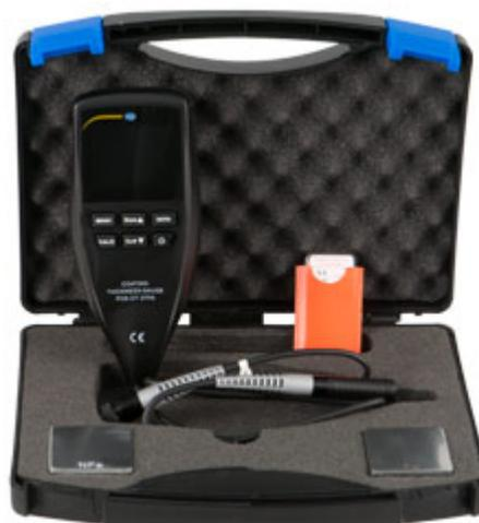
Le lamine di calibrazione per calibrare lo spessimetro hanno vari formati e servono per controllare la calibrazione.
