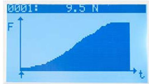
Misuratore di coppia: Analisi grafica dello sviluppo della torsione. È possibile consultare singoli valori.
