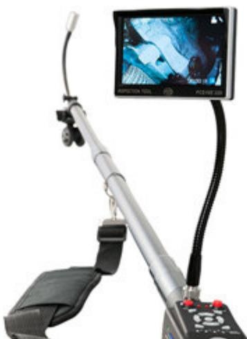
Unità di controllo e display LCD della telecamera telescopica
