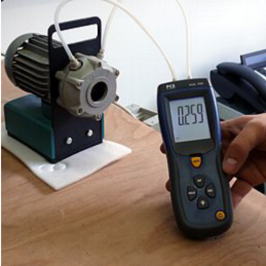
Qui può vedere il PCE-P01 mentre misura la pressione differenziale in una pompa a vuoto
