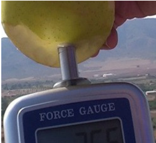
Penetrometro mentre determina la fermezza di una mela con un puntello da 11 mm
