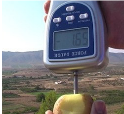
Penetrometro mentre determina la fermezza di una patata con un puntello da 8 mm
