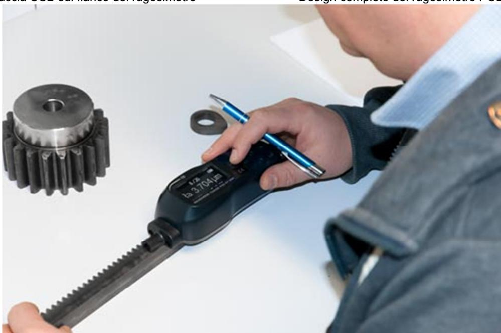
Misura effettuata con il rugosimetro PCE-RT 1200
