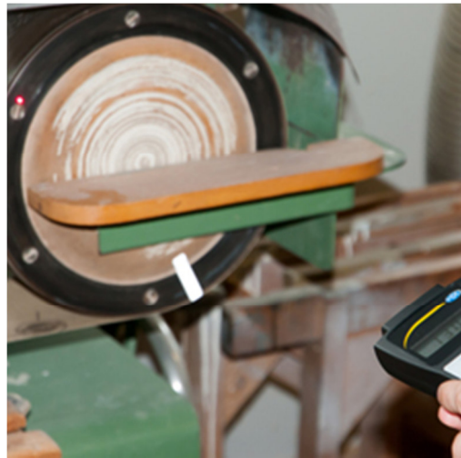
Misura ottica su levigatrice a nastro
