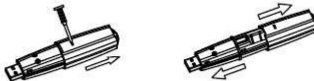
1. Premere sul vano-batteria e rimuovere il coperchio.
