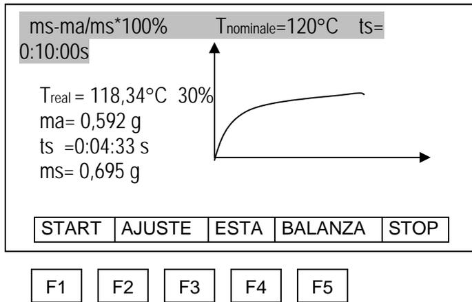
Una volta attivato il programma del processo collochi la prova del materiale e selezioni l'opzione *START* (tasto *F1*). Nel display compaiono la curva del processo e i parametri della misurazione.
