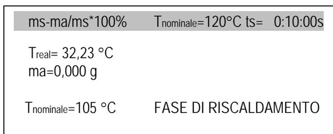
La fase di preriscaldamento non dura più di 1 minuto e riscalda la camera di essiccazione fino a + 105 °C. Se la temperatura di preriscaldamento supera i + 105 °C prescritti e la fase di preriscaldamento dura più di 1 min, dovrà interrompere il preriscaldamento nella camera di essiccazione premendo il tasto CLR e verificare possibili danni esistenti nello strumento (vedere paragrafo 15).
