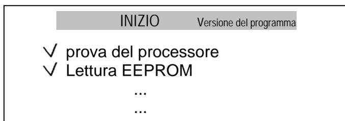
Successivamente la bilancia realizza una taratura automatica. Una volta portata a termine la taratura, la bilancia comincia con la fase di preriscaldamento. Una volta conclusa questa fase può dare inizio alla prima misurazione.
