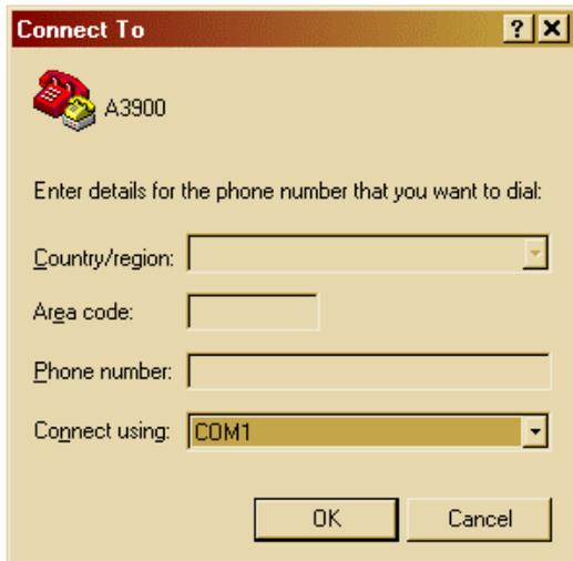
4) Selezionare i parametri di collegamento con nella figura sotto e premere OK.
