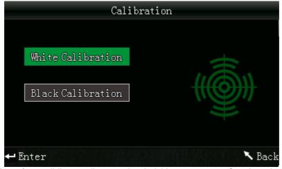
Per la calibrazione è possibile scegliere tra i colori bianco e nero. Con i tasti a freccia è possibile selezionare il colore ( ↑ e ↓ ) e premere poi il tasto . A quel punto appare una schermata di conferma con le relative istruzioni per la calibrazione.
