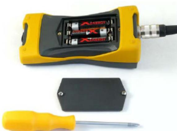
Si consegna con le pile inserite. Per cambiare le pile apra il comparto della batteria con un cacciavite a stella. Togliere le pile quando non usa lo strumento per molto tempo, o se lo vuole far funzionare solo mediante USB. Caricatore, accumulatore e alimentatore USB sono disponibili dal fabbricante o distributore.
