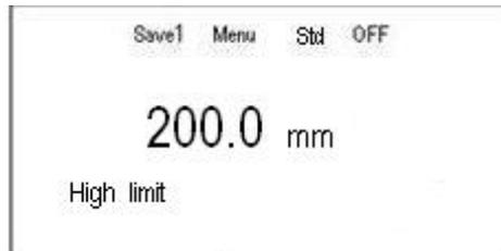
Per uscire dalla funzione di configurazione del valore massimo, premere il tasto Menu 4 volte e si ripristina il display principale.
