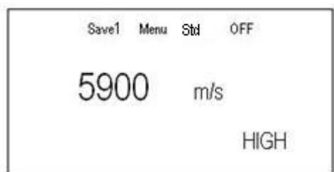
Quando appare questa schermata si colloca il gel di accoppiamento sulla sonda e si posiziona la sonda sul primo punto del blocco di calibrazione, dopo di che il misuratore comincerà a misurare. Dopo questo passaggio premere il tasto
