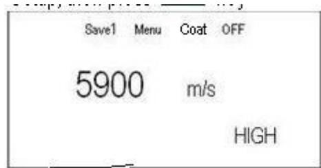
Ora si calibra il dispositivo a 4 millimetri premendo il tasto
