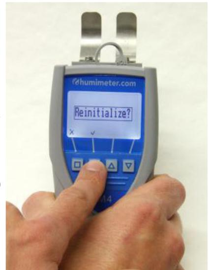
3. Selezionare la curva di calibrazione con i tasti ▲ o ▼. Il nome della curva di calibrazione appare nella parte superiore del display. Si prega di consultare le istruzioni.
