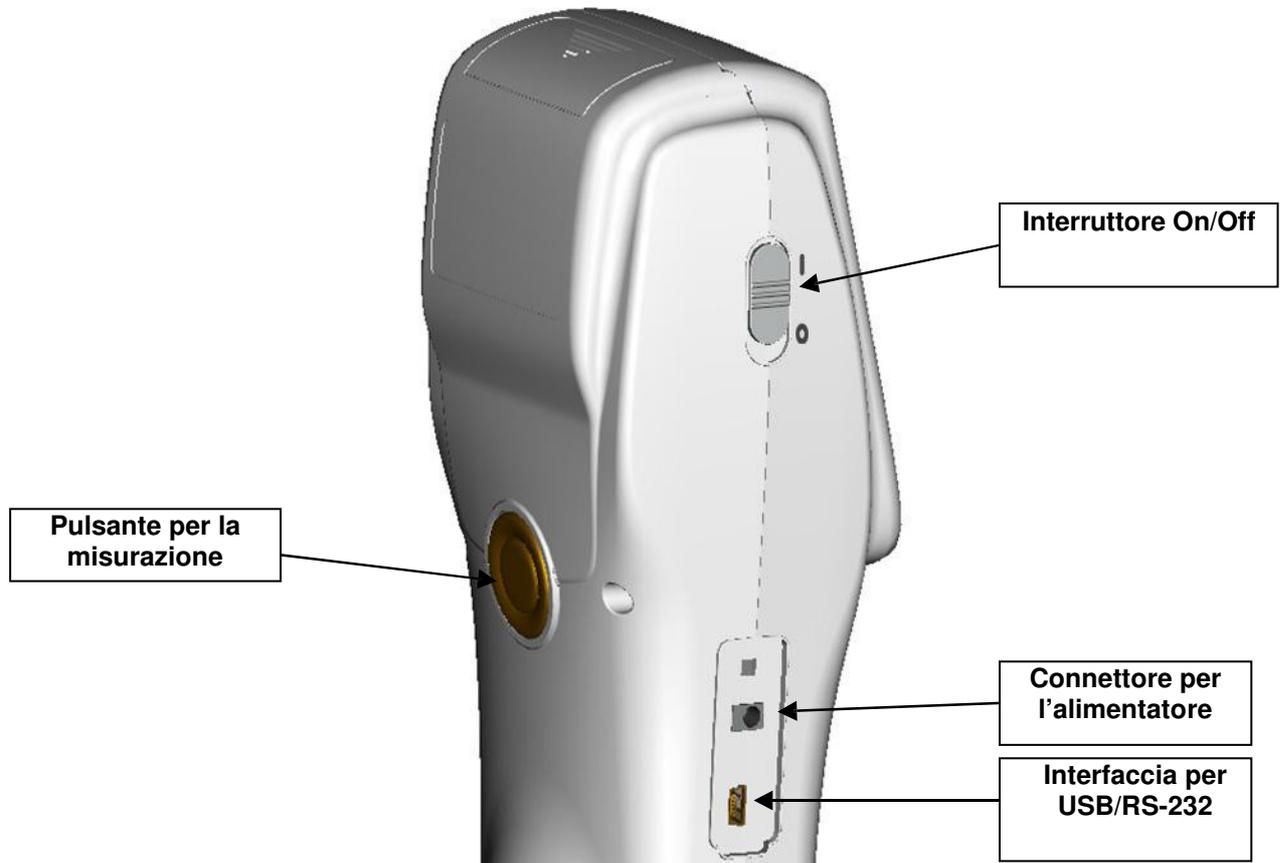
Fig. 1: Interfaccia / Connettore
