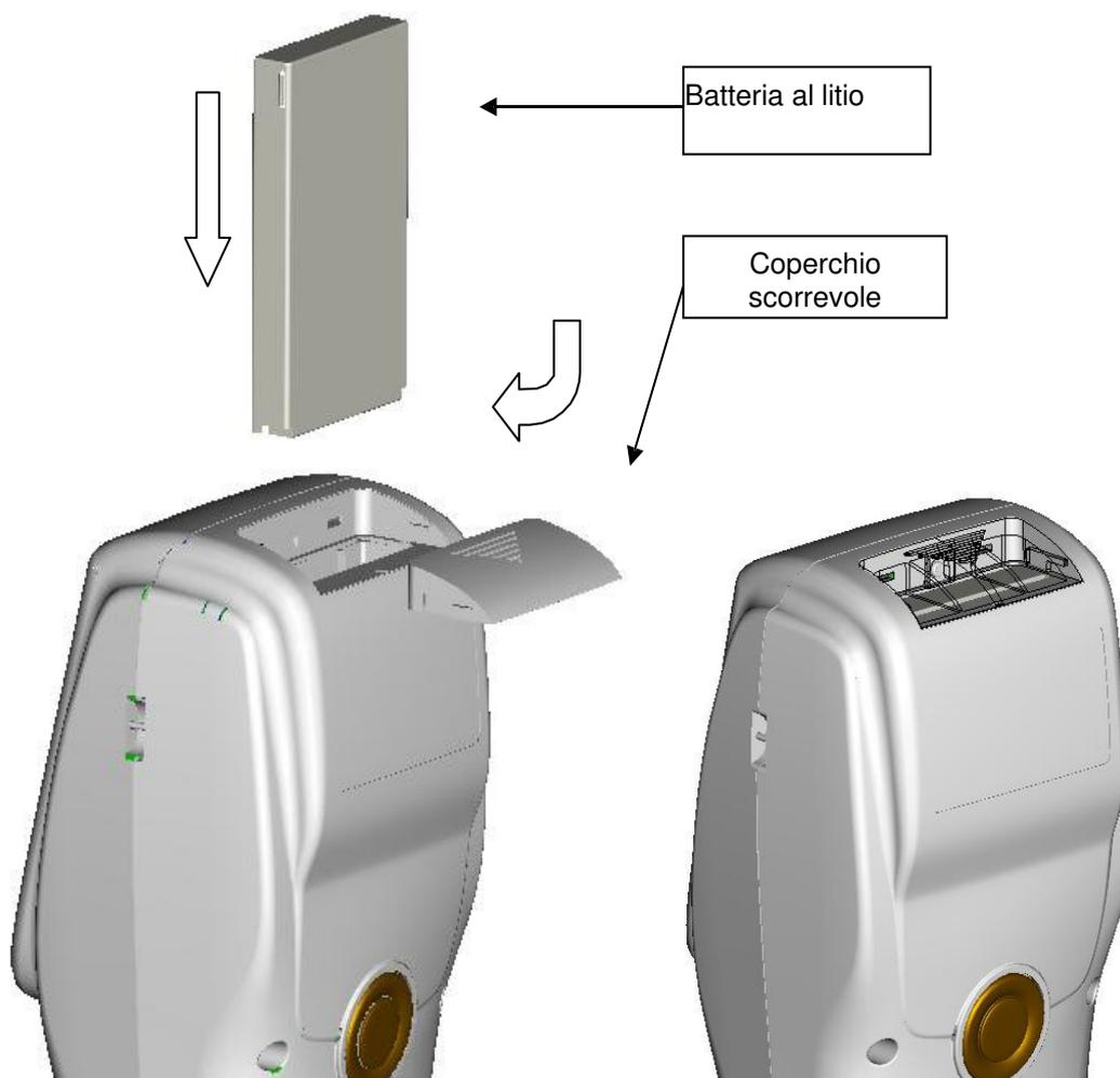
Fig. 2: Installazione della batteria
