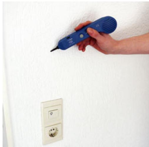
Test per rilevare interruzioni di cavi sotto un intonaco con il PCE-180 CBN
