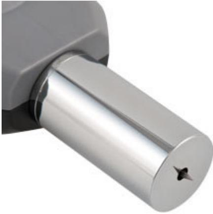
Punta del durometro per termoplastica PCE-DDD 10
