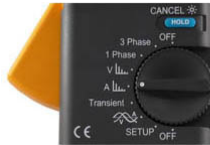
Selezione di funzioni in forma di commutatore rotatorio dell'analizzatore di armoniche PCE-GPA 62
