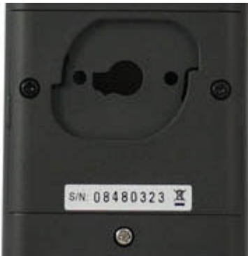
Interfaccia ottica nella parte posteriore dell'analizzatore di armoniche PCE-GPA 62
