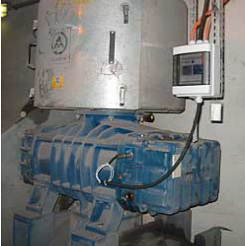
Monitoraggio di un macchinario che genera vibrazioni con l'analizzatore di vibrazioni piezoelettrico
