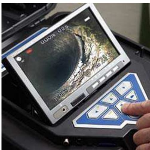
In questa immagine si può vedere il monitor dell'endoscopio VIS 300 / 350.
