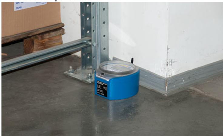
L'accelerometro per edifici è conforme alla norma DIN 4150-3 ed è usato principalmente per l'analisi di edifici e costruzioni
