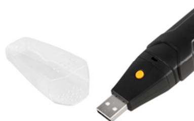
Il trasferimento dei dati viene effettuato tramite interfaccia USB
