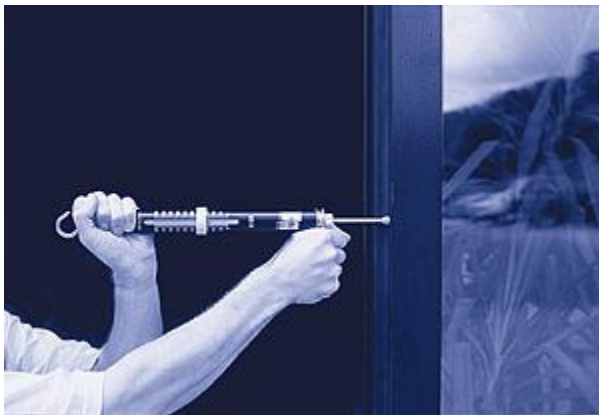
Bilancia a molla come misuratore di forza di compressione
