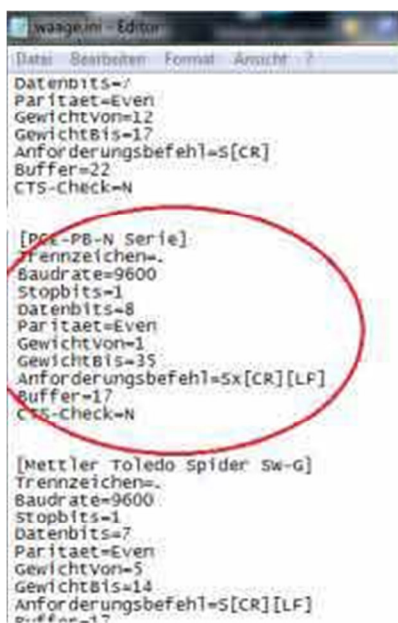
Connessione della bilancia industriale della serie PCE-PB N al software di GePard / EasyLog / DHL L'ordine di riferimento della bilancia industriale USB è Sx .
