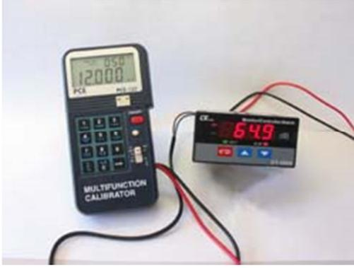
L'immagine a fianco mostra il PCE-123 mentre calibra il fonometro SLT. Il range di misura è di 30 ... 130 dB (A) per un segnale di ingresso di 4 ... 20 mA. Il calibratore multifunzione emette in questo caso un segnale regolato al 50%=12mA (range 4 - 20mA) che corrisponde ad un 50%=65 (64,9) dB(A). Può vedere la precisione con la quale opera il SLT.
