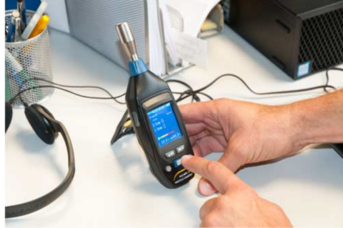
Il contatore di particelle esegue una misura ORIENTATIVA in un ufficio
