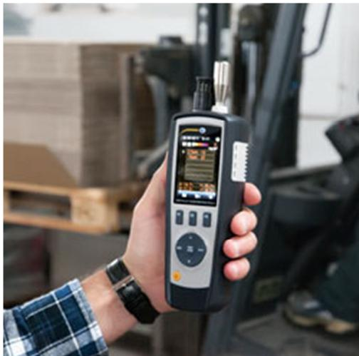
Il contatore di particelle PCE-PCO 2 durante una misura
